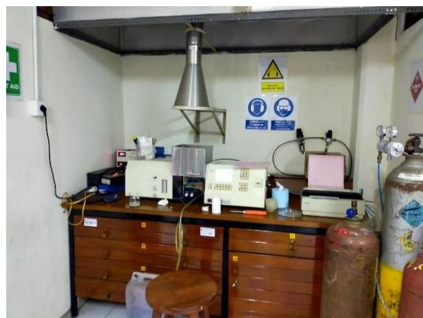
**Gambar 10.** Analisis logam Cd, Mn, dan Pb dengan SSA
