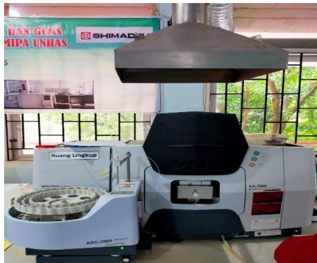
**Gambar 11.** Analisis logam Ca dengan SSA
