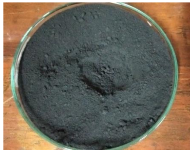
Karbon Tempurung Kemiri ukuran 200 mesh
