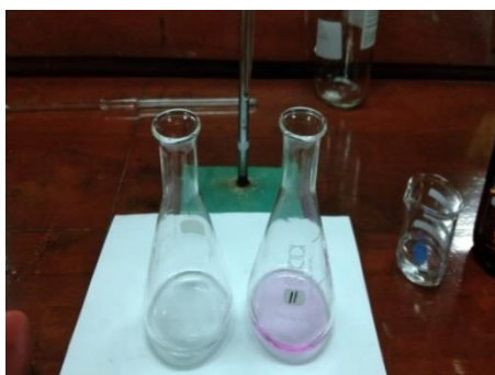
Standarisasi NaOH dengan H_2C_2O_4
