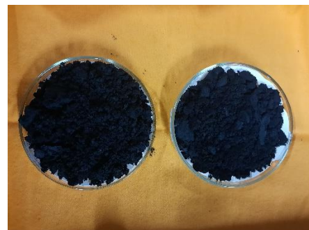
Karbon Aktif Setelah Pengeringan pada suhu 105^\circ C selama 2 jam
