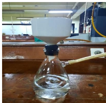
Penyaringan Karbon Tempurung Kemiri teraktivasi H_3PO_4
