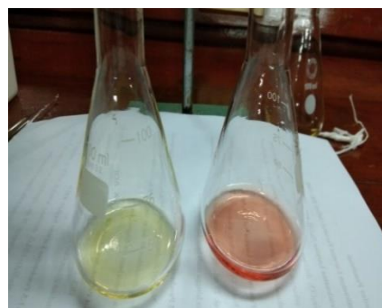
Standarisasi HCl dengan Na_2B_4O_7
