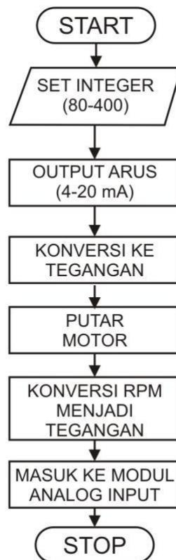
**Gambar III.4 Flowchart Rangkaian pengendali kecepatan motor**
