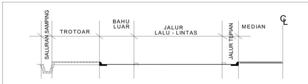
**Gambar 6.** Standar penempatan trotoar di sebelah luar bahu
