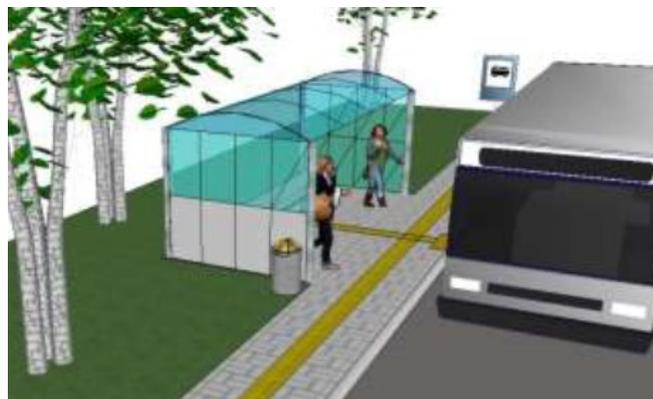
Gambar 15. Standar Halte yang Terletak di Belakang Jalur Trotoar
