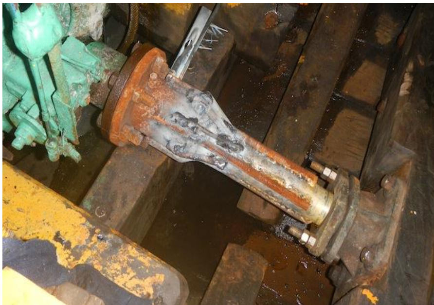
Sambungan antara mesin dan baling-baling (As)
