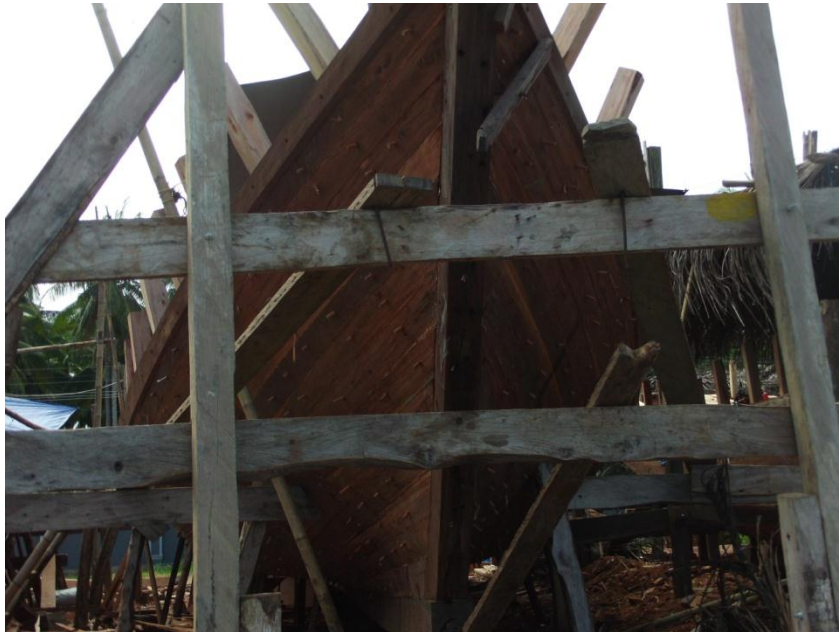
Tampak depan anjungan perahu yang sedang dikerjakan
