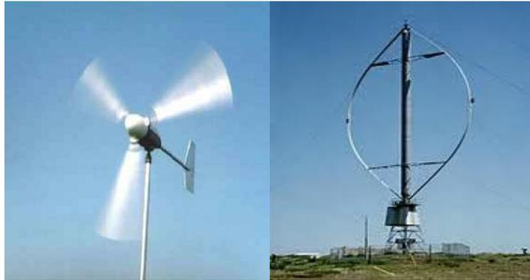
**Gambar 2.3 Turbin Angin Horizontal dan Turbin Angin Vertikal**
