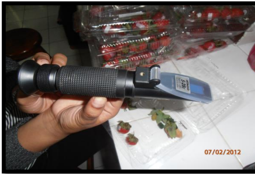
Gambar Lampiran 5. Pengukuran kadar gula stroberi dengan menggunakan refraktometer
