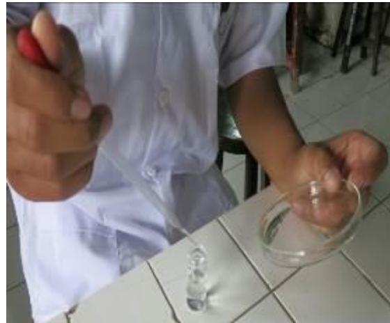
Pemipetan larva ke dalam vial uji
