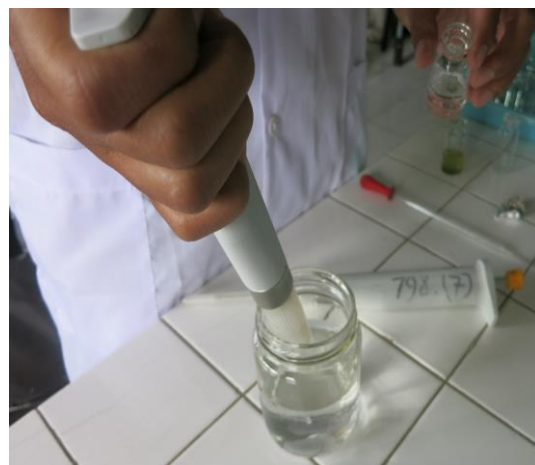
Kalibrasi air laut pada vial
