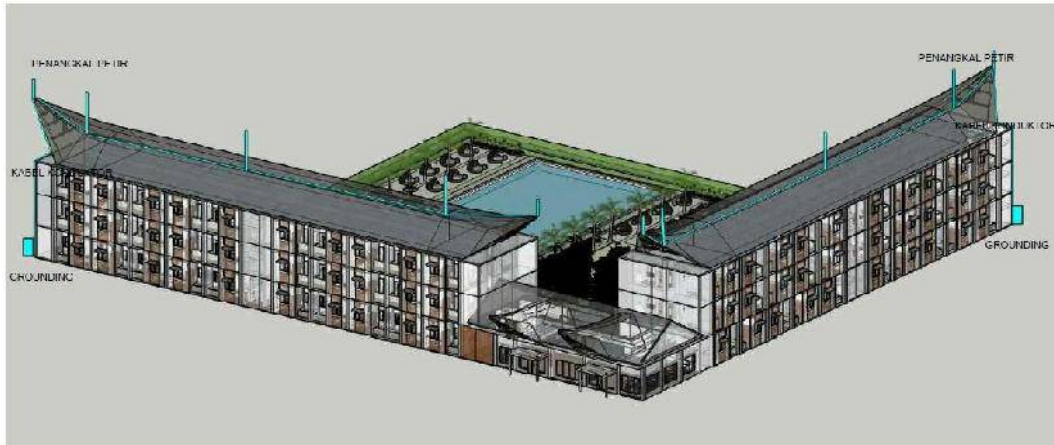
Gambar 7. Sistem Penangkal Petir Gedung Museum
