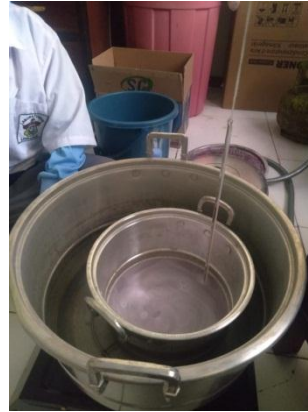
Proses Penyaringan dan Pasteurisasi Minuman Siap Konsumsi
