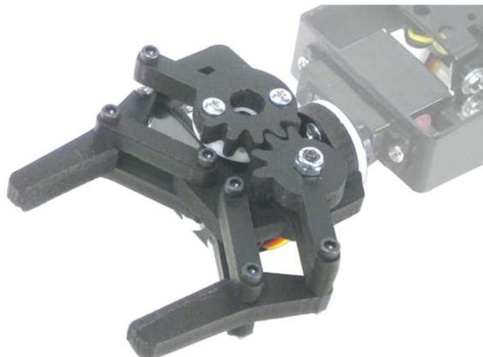
Gambar 8. Efector Sebuah Robot
