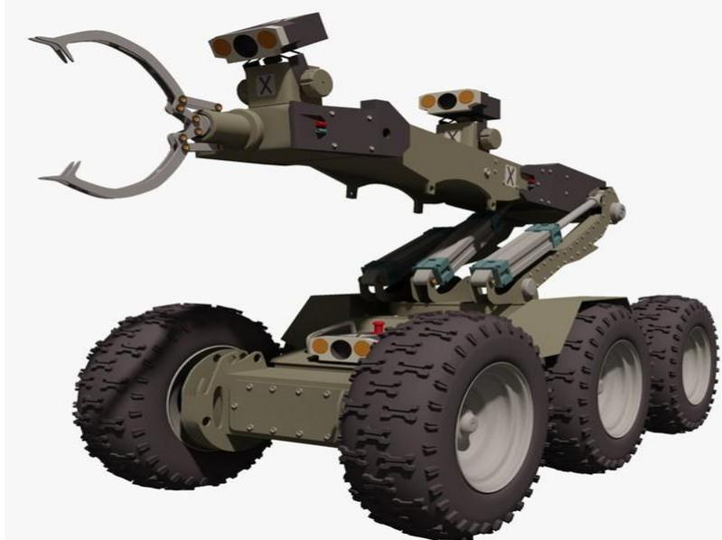
Gambar 2. Robot Mobile Manipulator Menggunakan 6 Roda
