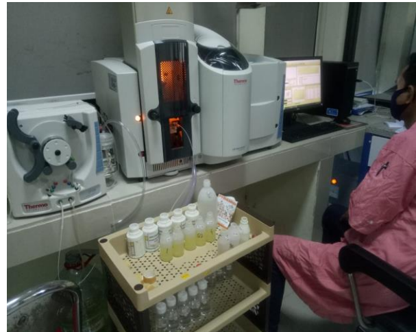
Pemeriksaan Kandungan Logam Berat pada Kerang dengan The Thermo Scientific™ iCE™ 3500 AA
