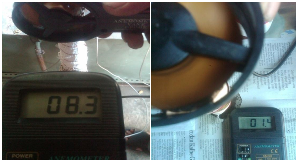
Gambar 12 Pengambilan data kecepatan gas buang keluar heat exchanger dan kecepatan udarah keluar alat pengering pada putaran mesin 1600 rpm
