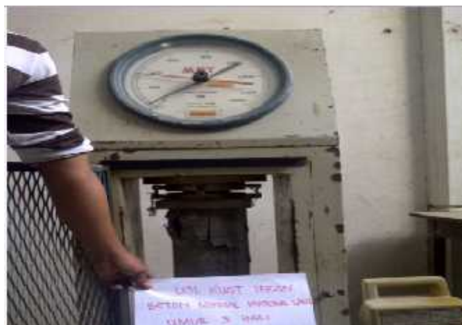
Pengujian Kuat Tekan Beton umur 3 hari
