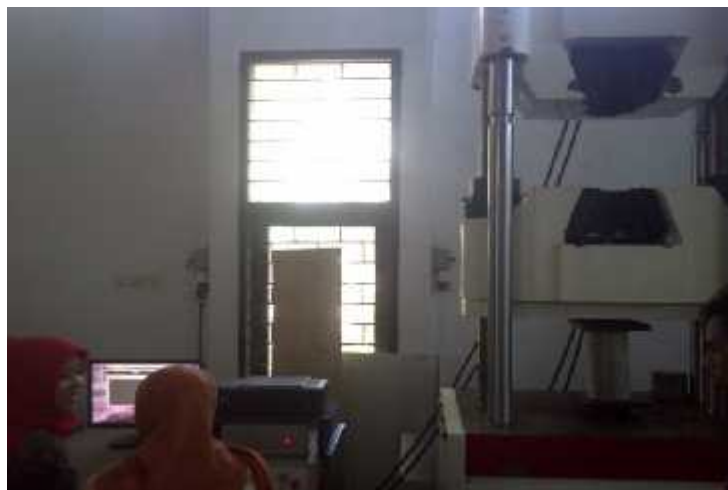
Pengujian Elastisitas Beton
