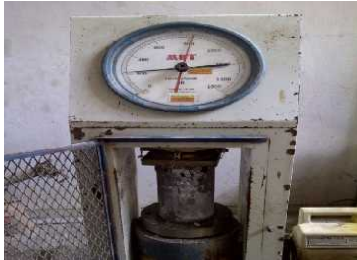
Pengujian Kuat Tekan Beton umur 28 hari
