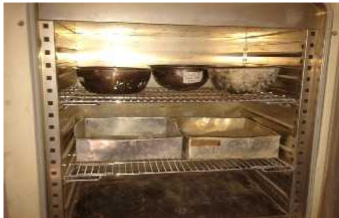
Pengeringan oven pada proses uji kadar air
