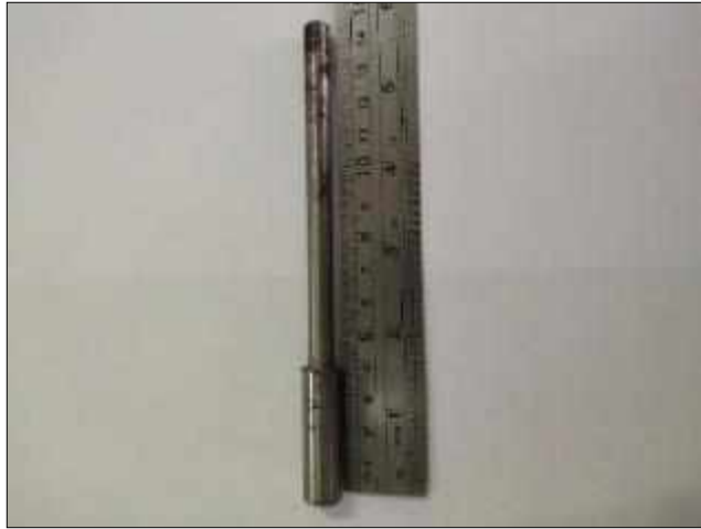
Spesimen Uji Fatigue
