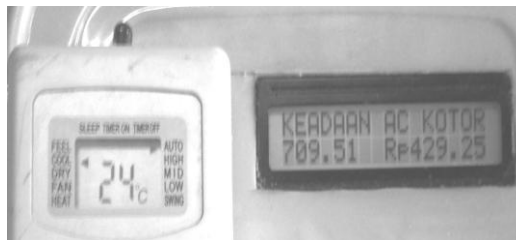
Besarnya energi listrik dan harga bayar 24°C saat penyaring udara AC kotor
