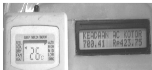
Besarnya energi listrik dan harga bayar 26°C saat penyaring udara AC kotor
