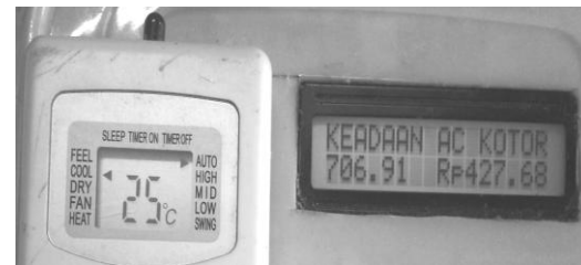
Besarnya energi listrik dan harga bayar 25°C saat penyaring udara AC kotor
