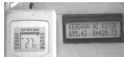
Besarnya energi listrik dan harga bayar 27°C saat penyaring udara AC kotor
