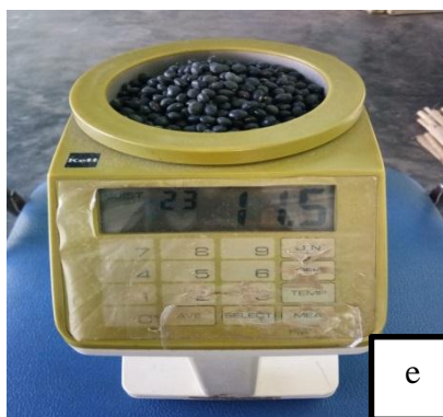
Gambar Lampiran 3. Tahapan Setelah Panen. Membersihkan akar (a), Memasukkan kedalam kantong (b), Pengeringan (c), Pemisahan polong dan biji (d), Pengukuran kadar air (e), Penimbangan biji (f),
