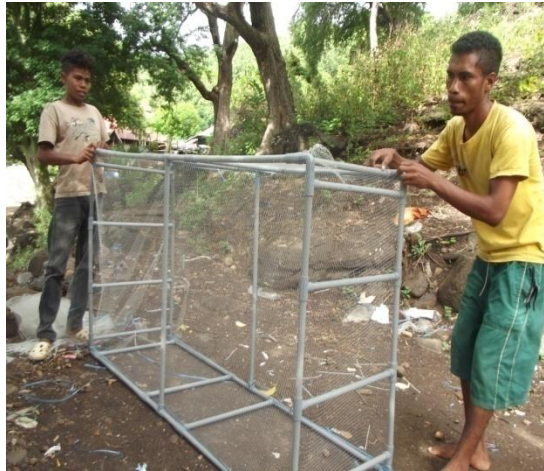
Pemasangan penutup badan bubu
