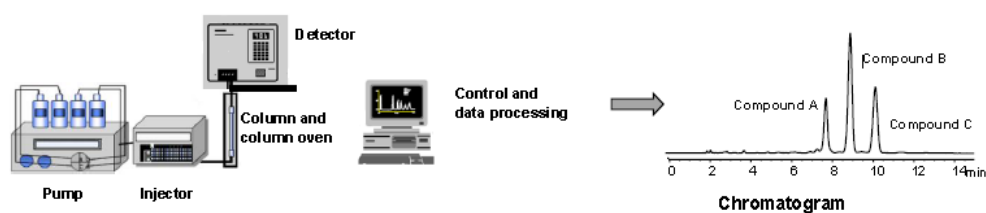
Gambar 5. Diagram sederhana Kromatografi Cair Kinerja Tinggi ( Sumber: Agilent Technology Inc.,2007)
