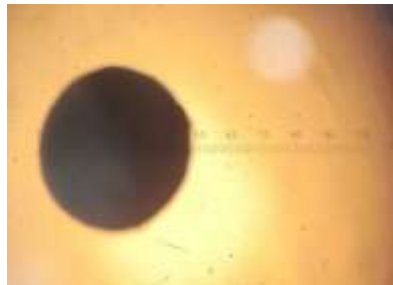
Gambar 11. Mikrokapsul salbutamol sulfat formula III dengan kecepatan pengadukan 700 putaran per menit (dilihat dengan mikroskop optik dengan perbesaran 4x10)
