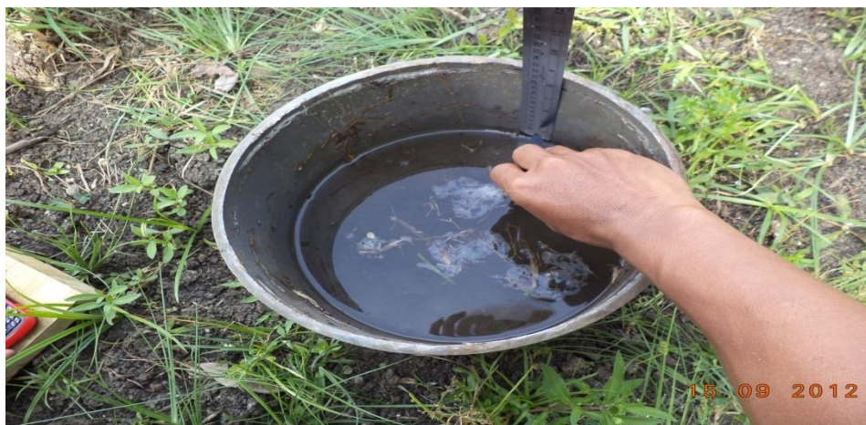
Gambar 6. Tabung infiltrometer sederhana
