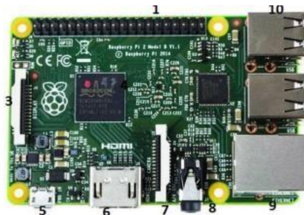
Gambar 2.7 Arsitektuk Raspberry Pi Model B (Sumber : Bambang. Y., Pulong Nugroho. S., Herianto, 2015)
