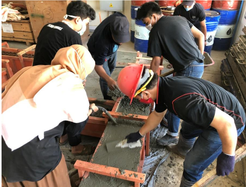
Pengecoran sampel beton monolit
