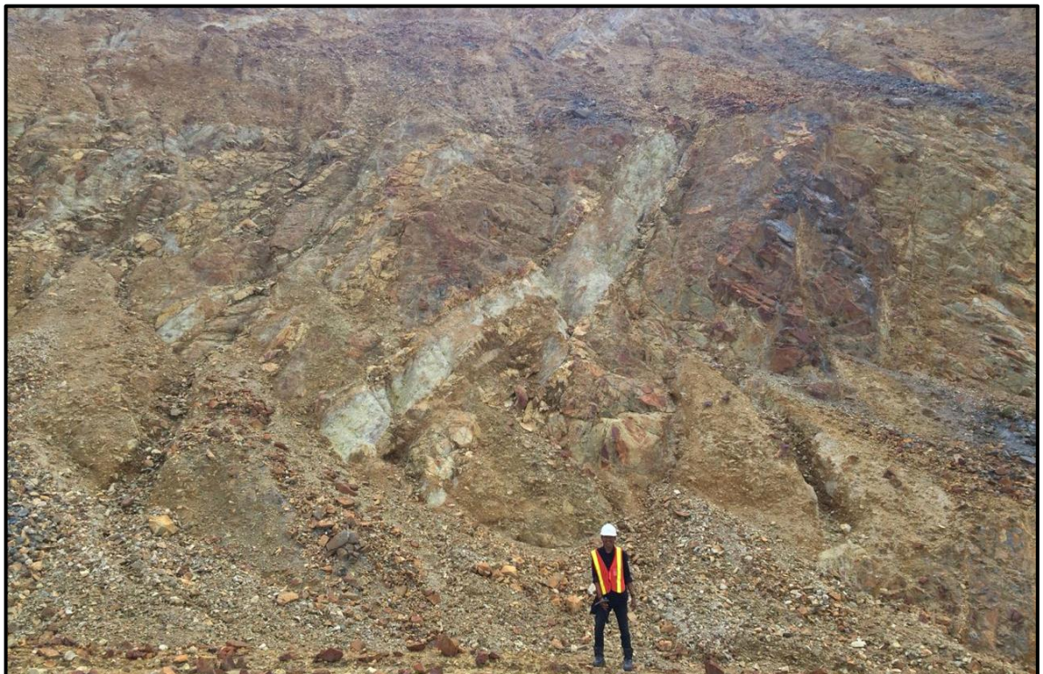
Aktivitas pengukuran bidang diskontinuitas pada Pit Batu Hijau PT AMNT
