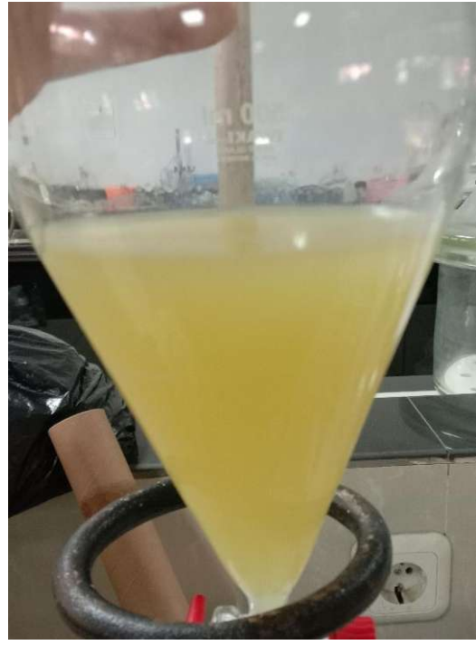
Fraksinasi dengan aseton + \text{Na}_2\text{CO}_3 10% (Tidak terbentuk 2 Lapisan)
