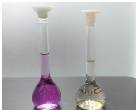
Perbandingan limbah simulasi tanpa reduksi dan setelah reduksi
