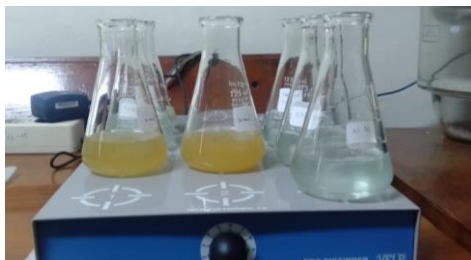
Pengadukan setelah penambahan koagulan \text{FeSO}_4 menggunakan multi magnetic stirrer
