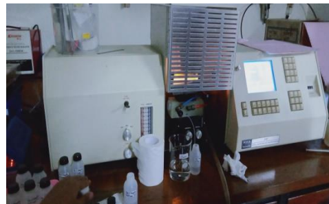
Proses Analisis Logam dengan SSA
