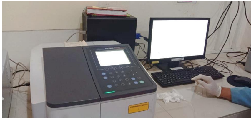
Proses Analisis Sulfat dengan Spektrofotometer UV-Vis
