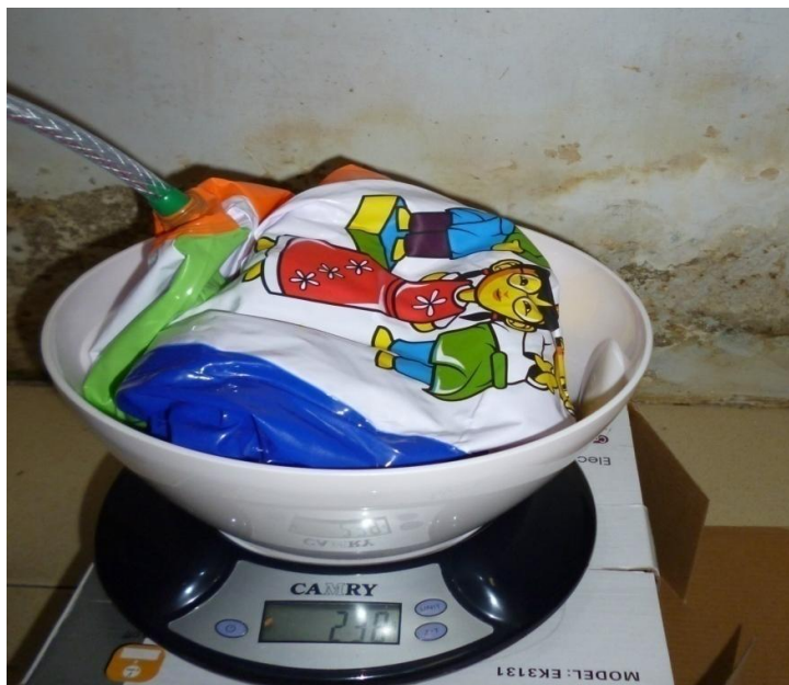
Gambar 9. Penimbangan balon (biogas)
