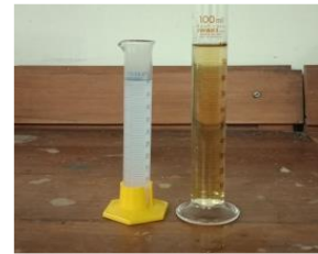
Pencampuran larutan kitosan dan gliserol (7:3)
