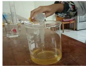
Pencampuran larutan kitosan dan gliserol (7:3)
