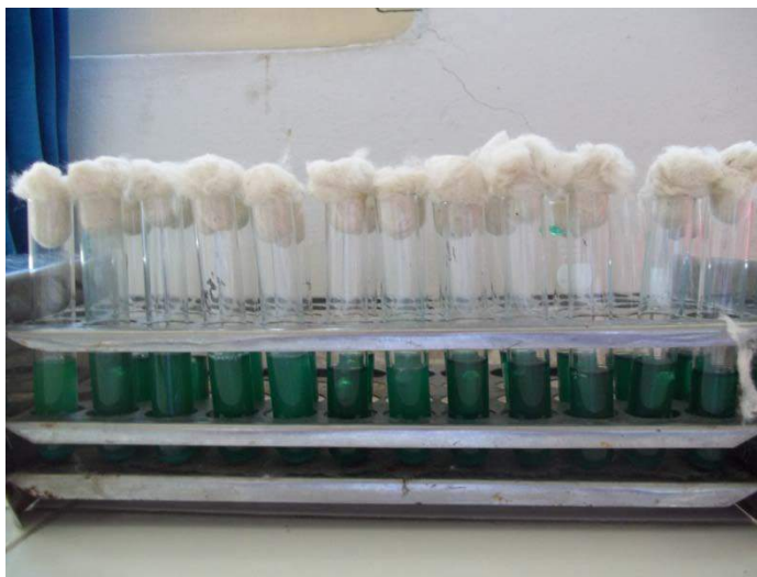
Gambar 5. Hasil Uji pada media Brilliant Green Lactose Broth positif ditandai dengan terbentuknya gas pada tabung durham.
