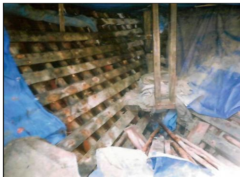
Gambar 11. Ruang muat kapal pinisi tanpa sekat tubrukan
