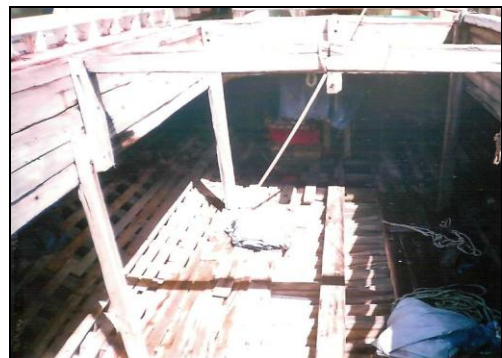
Gambar 12. Ruang muat kapal pinisi tanpa sekat tubrukan
