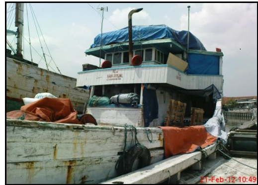
Gambar 14. Pemadatan muatan sampai geladak navigasi
