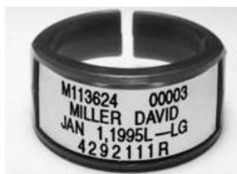
Gambar 2.2 Cincin Dosimeter
