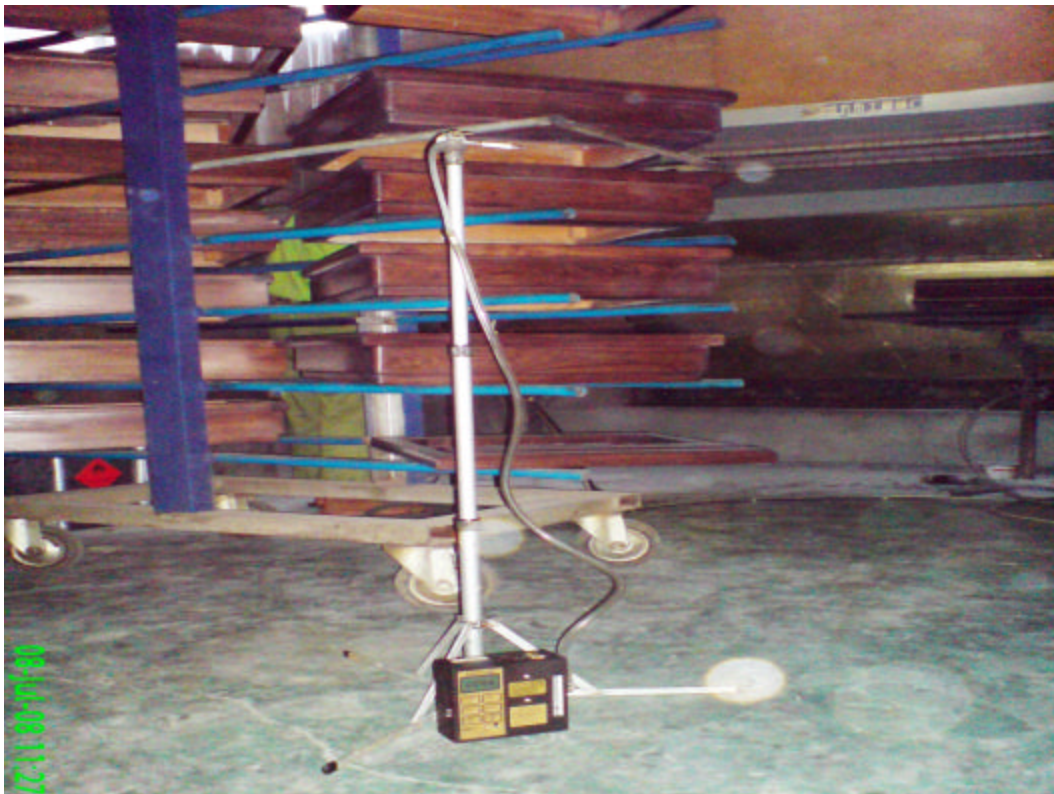
Gambar 6 : Pengukuran Konsentrasi benzena di Unit Finishing Painting
