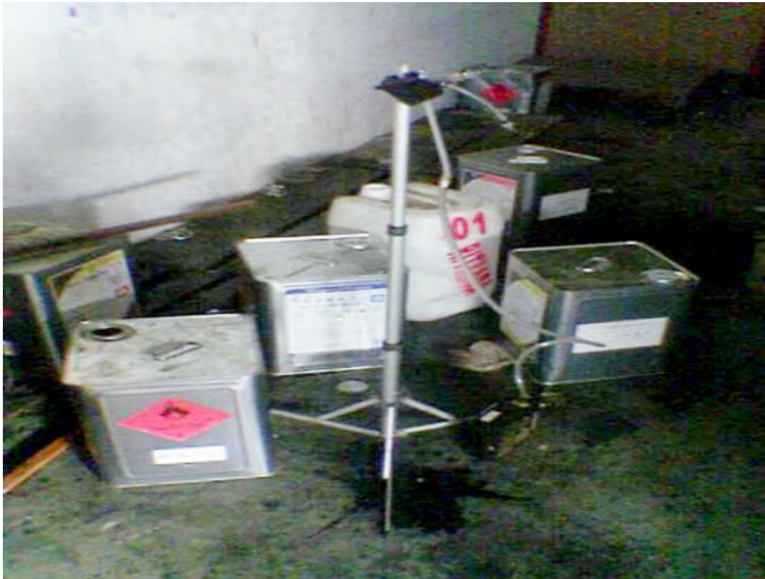
Gambar 3 : Pengukuran Konsentrasi Benzena di Udara Bagian Pengecatan
