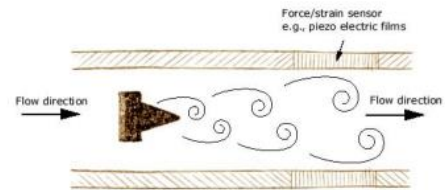
Gambar 4. Prinsip Kerja Vortex Flowmeter.
