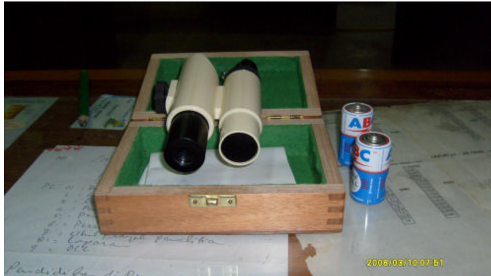
Alat pembaca lebar retak
