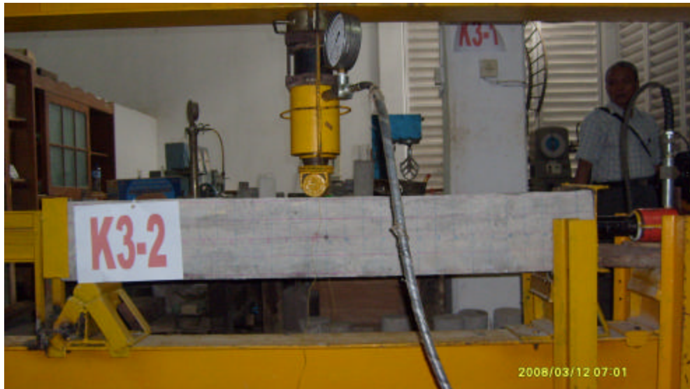
Benda uji kolom sebelum dibebani
