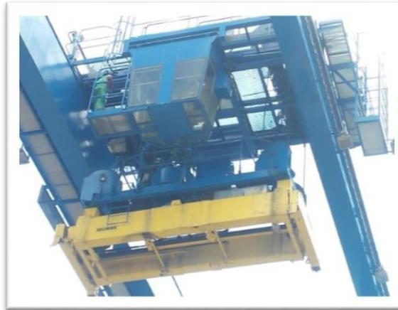
Tali sling RTG yang kendor sehingga pihak terkait turuntangan untuk memperbaiki dan melakukan maintenance alat
