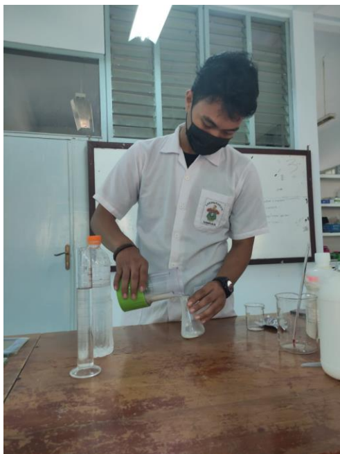
Proses penuangan kasein yang telah diblender ke dalam erlenmeyer
