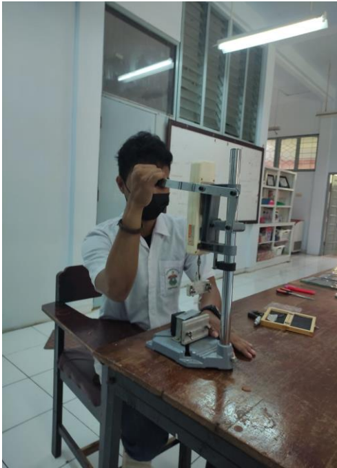
Pengujian Kuat Tarik dan Kemuluran Edible Film
