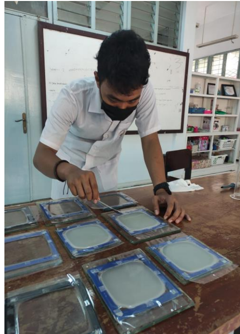
Perataan larutan yang telah dituang ke cetakan
