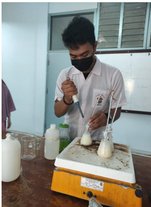
Penambahan Plasticizer ke dalam Larutan
