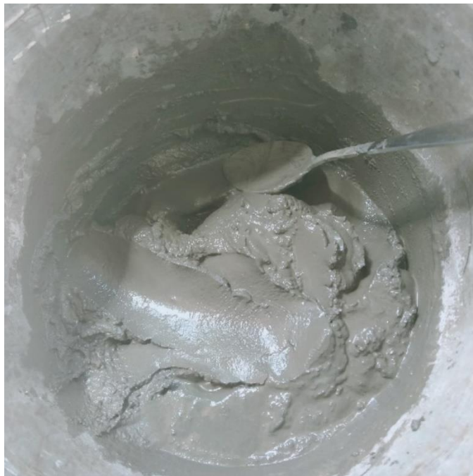
Gambar 12 Campuran semen dan serbuk besi dengan air yang siap untuk jadi material pengisi
