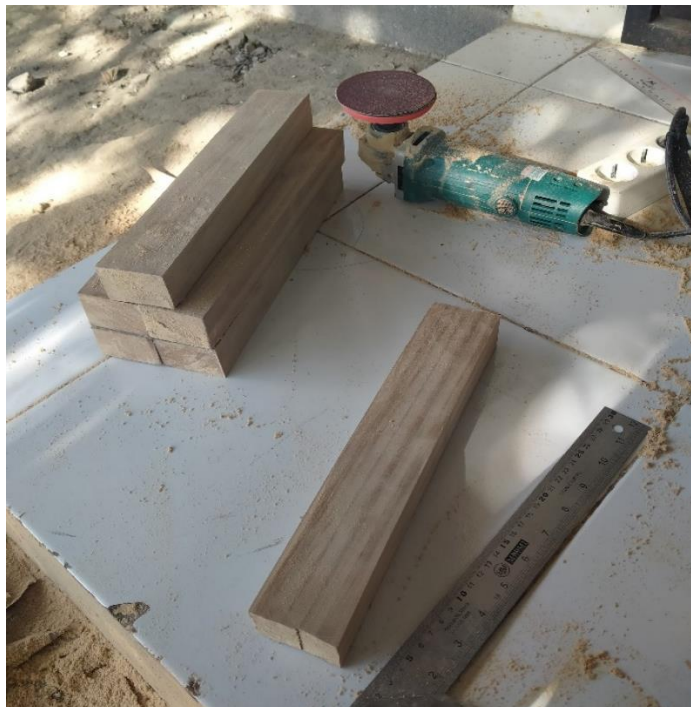
Gambar 2 Proses meratakan atau memperhalus Permukaan balok
