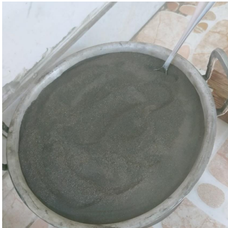
Gambar 10 Serbuk besi yang sudah disaring
