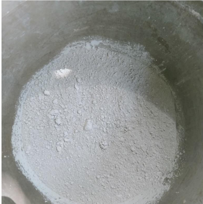
Gambar 11 Campuran semen dengan serbuk besi
