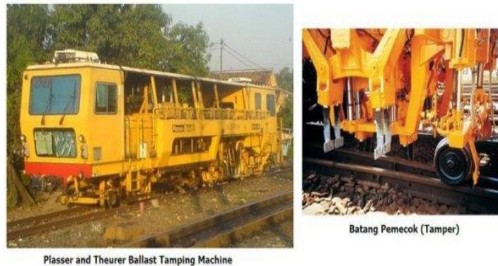
**Gambar 2.2** Mesin pemecok *ballast*
