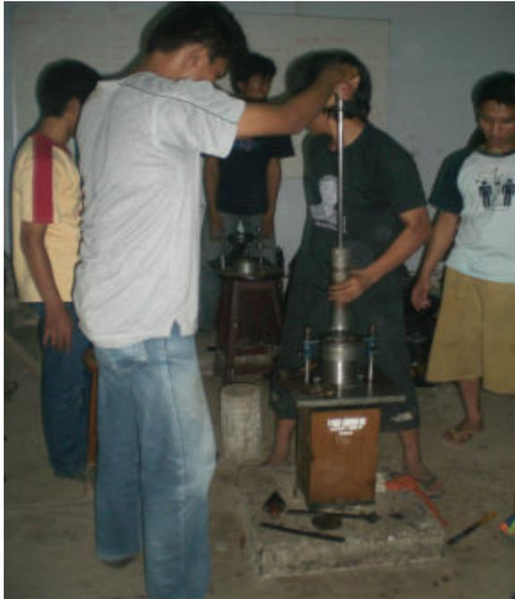
Gambar D11. Penumbukan Campuran Dalam Mold
