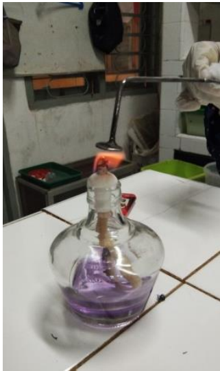
4. Proses pemanasan plat besi dengan menggunakan api bunsen
