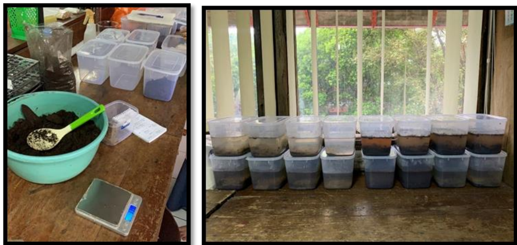
Desain bioreaktor dengan pemberian sedimen sawah dan kompos sebagai sumber inokulum bakteri pereduksi sulfat.
