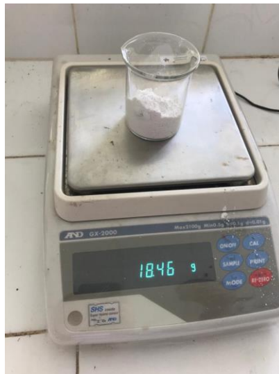
Gambar j. Penimbangan Kapur untuk Penetralan pH Air Limbah Tahu
