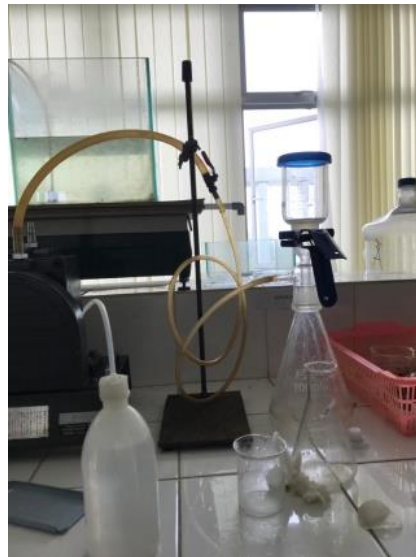
Gambar m. Pengujian Sampel untuk TSS
