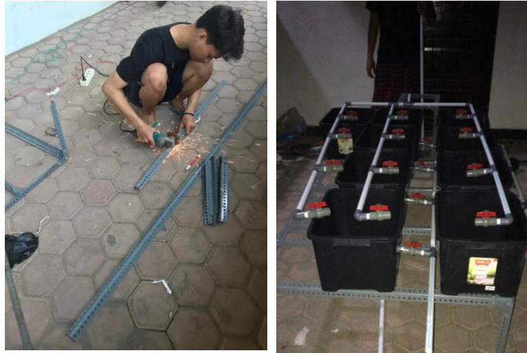
Gambar a. Pembuatan Rangka Reaktor dan Pemasangan Pipa disetiap Reaktor
