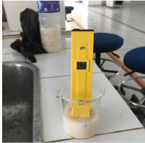
Gambar i. Pengukuran awal pH air limbah tahu
