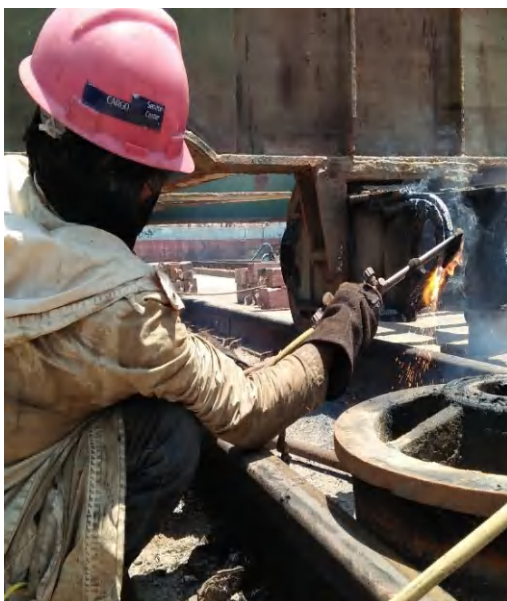
Pengerjaan Brender pada as roda di Shifter
