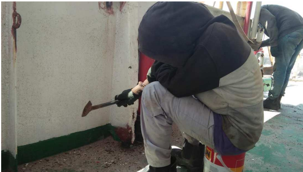
Proses pengerjaan Palu-palu pada deck kapal
