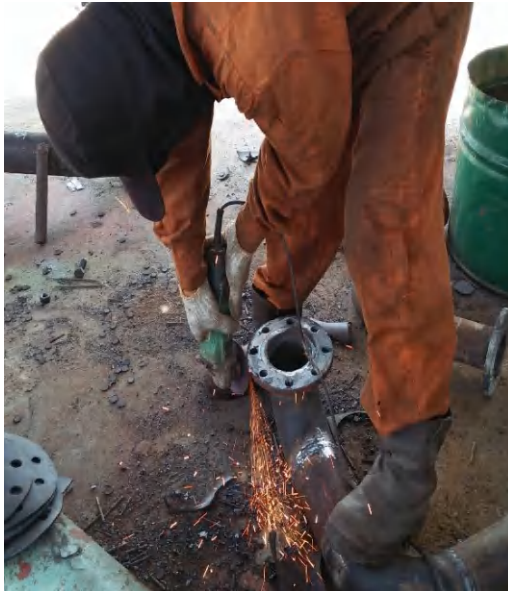
Proses pengerjaan Gurinda pada pipa di main deck
