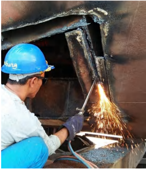
Pengerjaan Brender pada lambung kapal dan bollard
