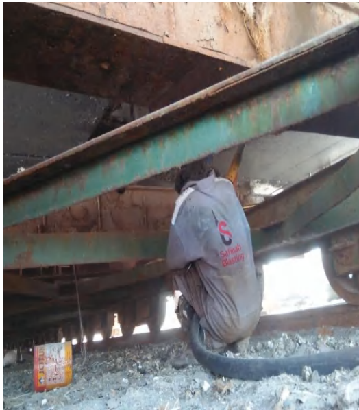
Pengerjaan sandblasting pada lambung kapal
