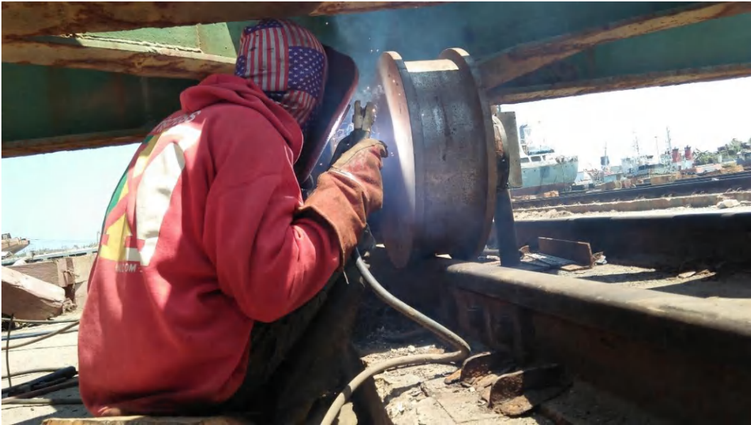
Proses pengelasan as roda pada Shifter
