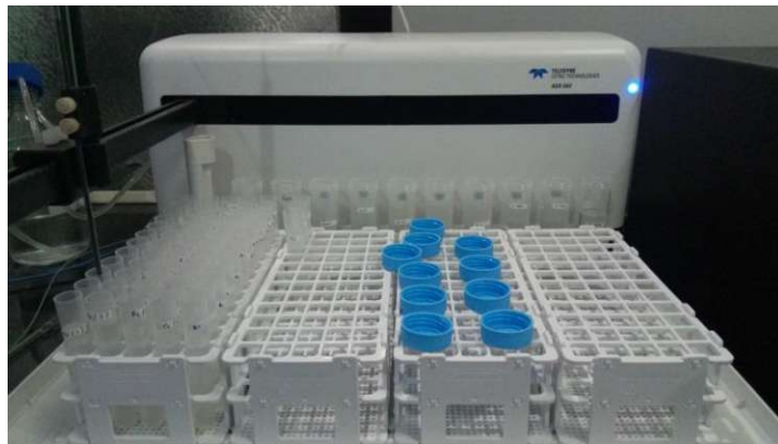
Proses analisis dengan ICP-OES
