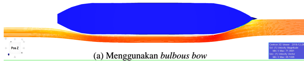
Gambar 10. Visualisasi Perbandingan pola aliran fluida model kapal pada kecepatan aliran 0,569 m/s
