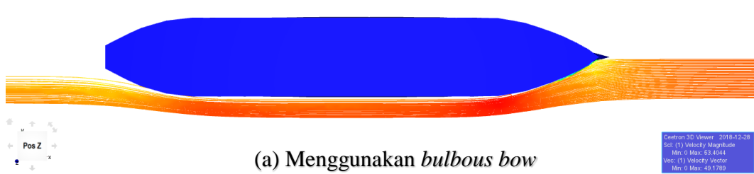
Gambar 8. Visualisasi Perbandingan pola aliran fluida model kapal pada kecepatan aliran 0,406 m/s
