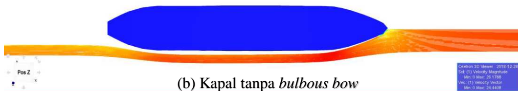
Gambar 6. Visualisasi Perbandingan pola aliran fluida model kapal pada kecepatan aliran 0,244 m/s
