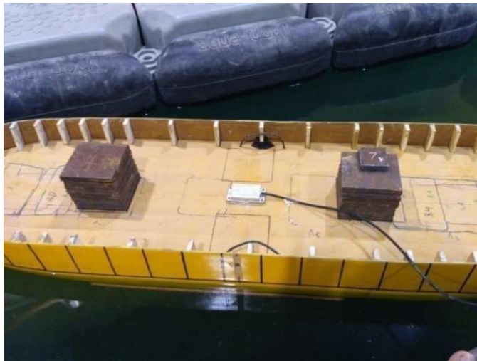
Gambar 24. Inclinometer Digital dipasang di model kapal
