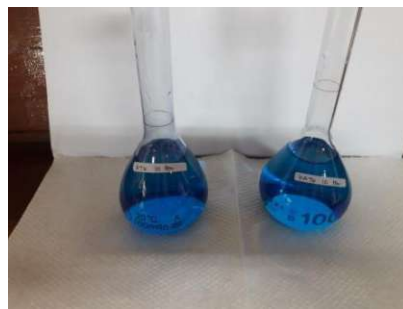
Penentuan Luas Permukaan dengan Metilen Biru
