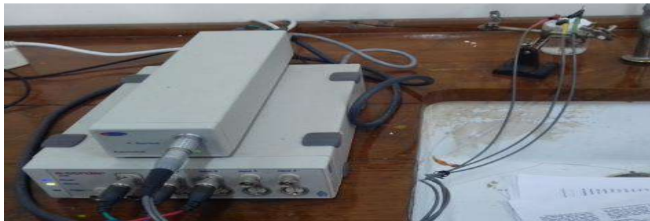
Proses pengukuran kapasitansi spesifik menggunakan alat Potensiostat.
