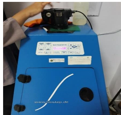
Pembacaan gel ( agarose ) dari bak elektroforesis di bawah sinar Ultra Violet Transilluminator
