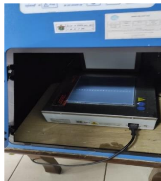
Pembacaan gel ( agarose ) dari bak elektroforesis di bawah sinar Ultra Violet Transilluminator
