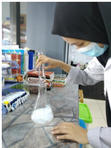
Pencampuran Larutan TAE ke dalam Agarose
